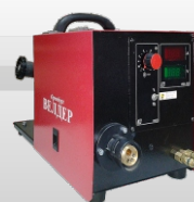
Спутник L/M кассета проволоки: Ø200/300мм 17 кг
